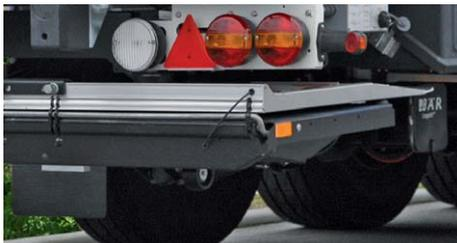
Система платформы **BAret45VLL-R21** с неподвижной частью из стали со звукопоглощающим покрытием SilentGrip, а также складной частью из натурального алюминия (серия). Алюминиевая складная часть поставляется также с **анодированием** (опция).
