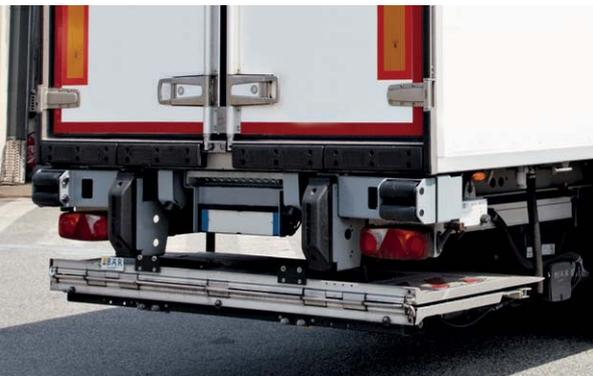
Для профессионального использования однократно складываемых, убираемых вниз гидробортов модель BC 2500 R4T отличается уникальным соотношением собственного веса и грузочной способности. Платформа глубиной до 2010 мм и значительный грузовой момент 25,0 кНм обеспечивают надёжность транспортировки даже тяжёлых громоздких грузов. Доступен разгруженный вариант, имеющий допустимую нагрузку 2 тонны.
