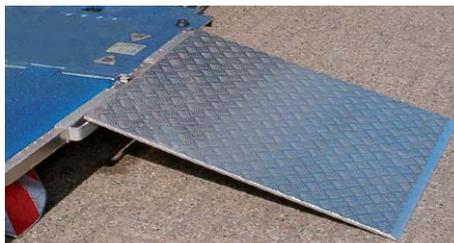
**Перегрузочная пластина** (опция) для боковой загрузки. Длина 1000 мм, ширина 860 мм.
