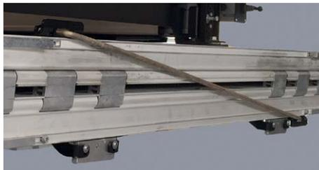
Ручное складывание окончания платформы удобно для оператора за счёт **снятия нагрузки с пружины** (серия).
