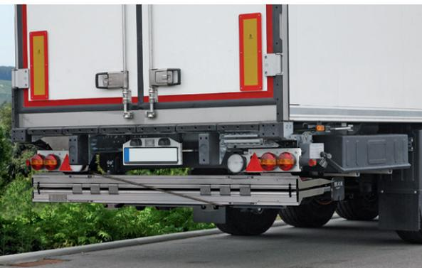
Оптimalен для монтажа на седельном полуприцепе благодаря высокой степени предварительной сборки и подвеске с захватом, быстро готов к использованию благодаря однократному складыванию платформы – так можно описать любой гидроборт из группы изделий RetFalt. BC 2000 R2T используется, прежде всего, для транспортировки тележек или для палет вилочным автопогрузчиком.
