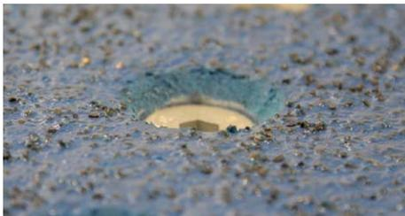
Звукопоглощающее покрытие Bär **SilentGrip** для поверхности платформы в Piek-варианте толще.
