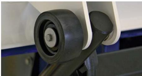
На уровне земли (пола) дополнительное резиновое покрытие **напольных роликов поглощает шум**. Все грузовые подъемники S4 в Piek-версии оборудованы **агрегатом тихого хода**.
