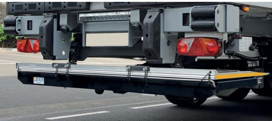
Высокая степень предварительной сборки в сочетании с гибким использованием без необходимости значительного техобслуживания – это достоинство гидроборта Bär Cargolift RetFalt. Эти убираемые вниз гидроборта с помощью прикрученной подвески могут быть быстро смонтированы на грузовом транспортном средстве или с помощью подвески с захватом – на седельном полуприцепе.
