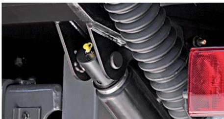
Гидроцилиндр с **защитной трубой** или **гофрированным чехлом** (серия) как защита от удара камнями и от коррозии. Одновременно быстрое автоматическое открывание с помощью цилиндров наклона двойного действия – даже в зимнее время.
