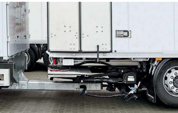
Как гидроборт для грузовых транспортных средств с несъемным или сменным фургоном, а также с низкорасположенным узлом сцепки модель BC 1500 R4U, наряду с быстрым монтажом, обеспечивает большую свободу хода для дышла. Кроме того, высокий грузовой момент 15,0 кНм обеспечивает возможность практического использования в транспортных распределительных системах.
