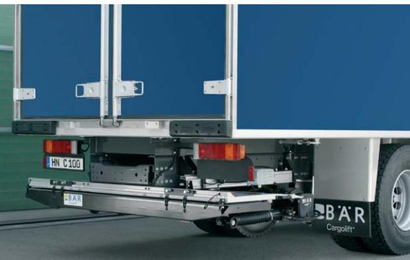
Как гидроборт для грузовых транспортных средств с допустимым общим весом 8,6-18,0 т и несъёмными фургонами любого вида модель BC 1500 R21 пригодна для разностороннего использования. Её платформа глубиной 1710 мм обеспечивает возможность транспортировки тележек или палет вилочным автопогрузчиком. Кроме того, этот однократно складываемый и убираемый вниз гидроборт может быть быстро приведён в состояние готовности к использованию.
